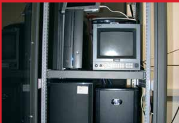
Cabecera de emisión desarrollada por el G@TV. Estaciones de adquisición de flujos, inyección de vídeo, equipo de control de tramas MPEG y monitorado de referencia.
