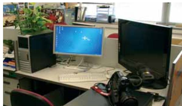
Cámara HDV, equipo de ingesta, monitor HD, estación de edición y pantalla LCD HD-Ready del puesto de adquisición y producción de contenidos del laboratorio del G@TV.
