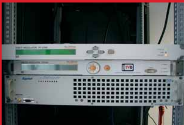
Modulador DVB-T y equipo de potencia de la cabecera de emisión del G@TV.
